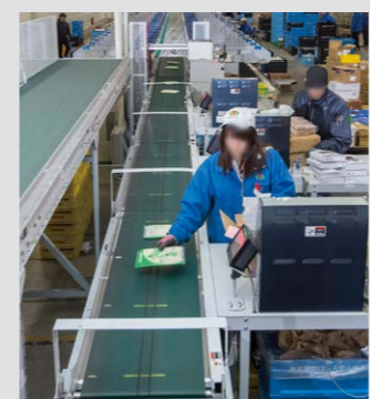
パラ物自動仕分けシステム「PAS」/ユニバーサルデザイン対応
