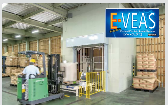
「BCP対応」パレット搬送用垂直往復搬送機オートレーター
