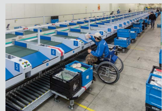
パラ物自動仕分けシステム「PAS」/ユニバーサルデザイン対応
