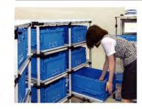
作業者が商品データを入力すると 仕分け先の棚(可動式棚板)が自 動的に飛び出します。その棚(ケース)に商品を入れ、棚を確実に押し 込むと仕分け実績が上がるという シンプルなしくみですのでヒューマ ンエラーが発生しません。
